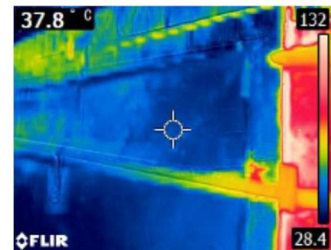
遮熱 シート 約30°C 遮熱塗料 施工後 約160°C
